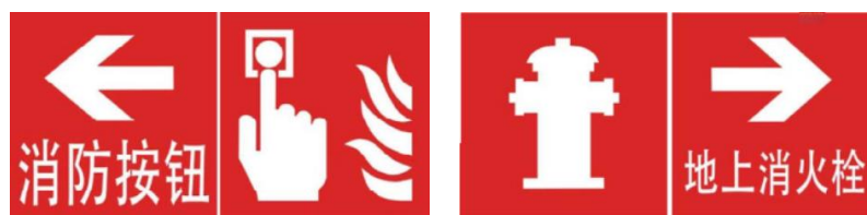
图 B.21 标志、方向辅助标志与文字辅助标志组合使用图例
