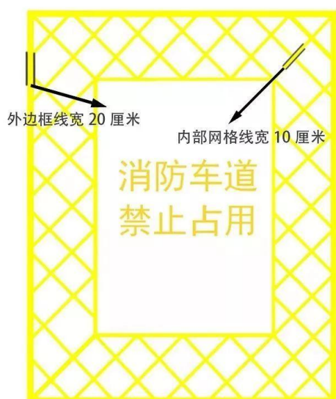
图 B.5 消防车通道出入口禁停标线及路面警示标志图例
